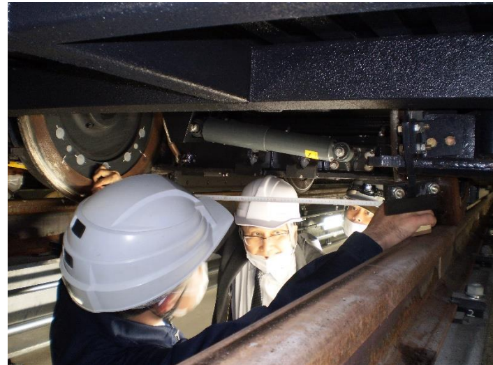
車輪間の距離測定
