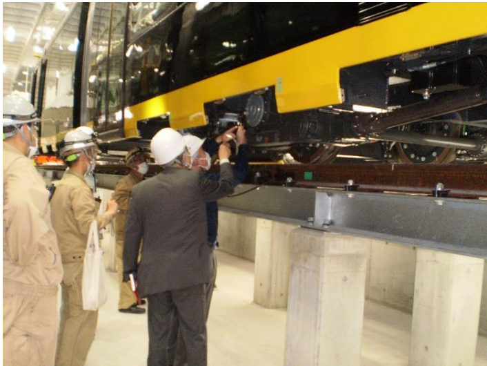
台車と車体との離隔測定
