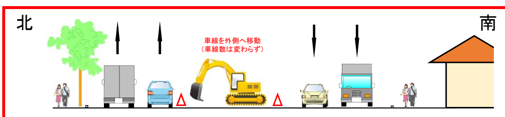
(2) 中央分離帯の撤去
