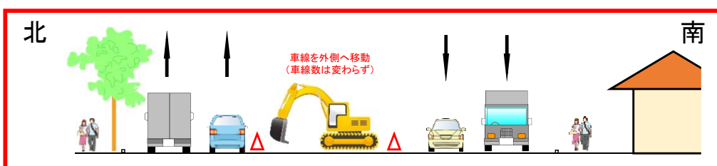
(2) 中央分離帯の撤去
