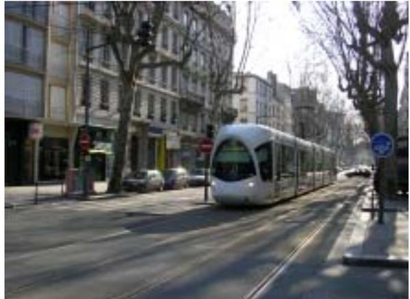
図 LRT片寄せの例
