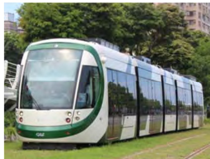
省電力の架電レスLRT車両 景観性が抜群に良い！
