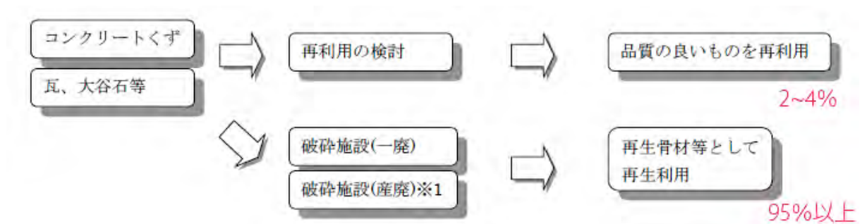
図5 災害により発生した大谷石の処理フロー（栃木県東日本大震災に係る災害廃棄物処理計画）
