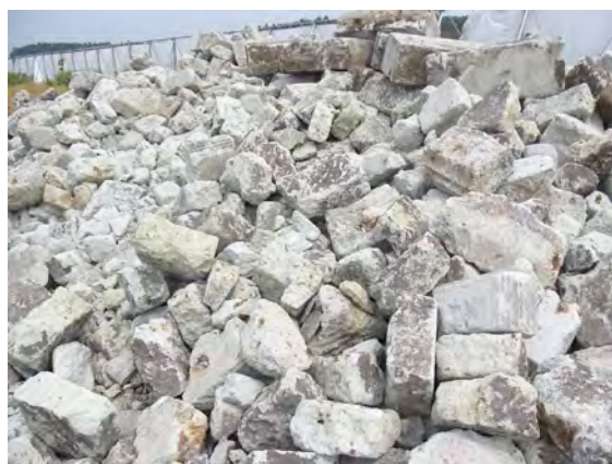
図3 損傷の激しいがれき大谷石
