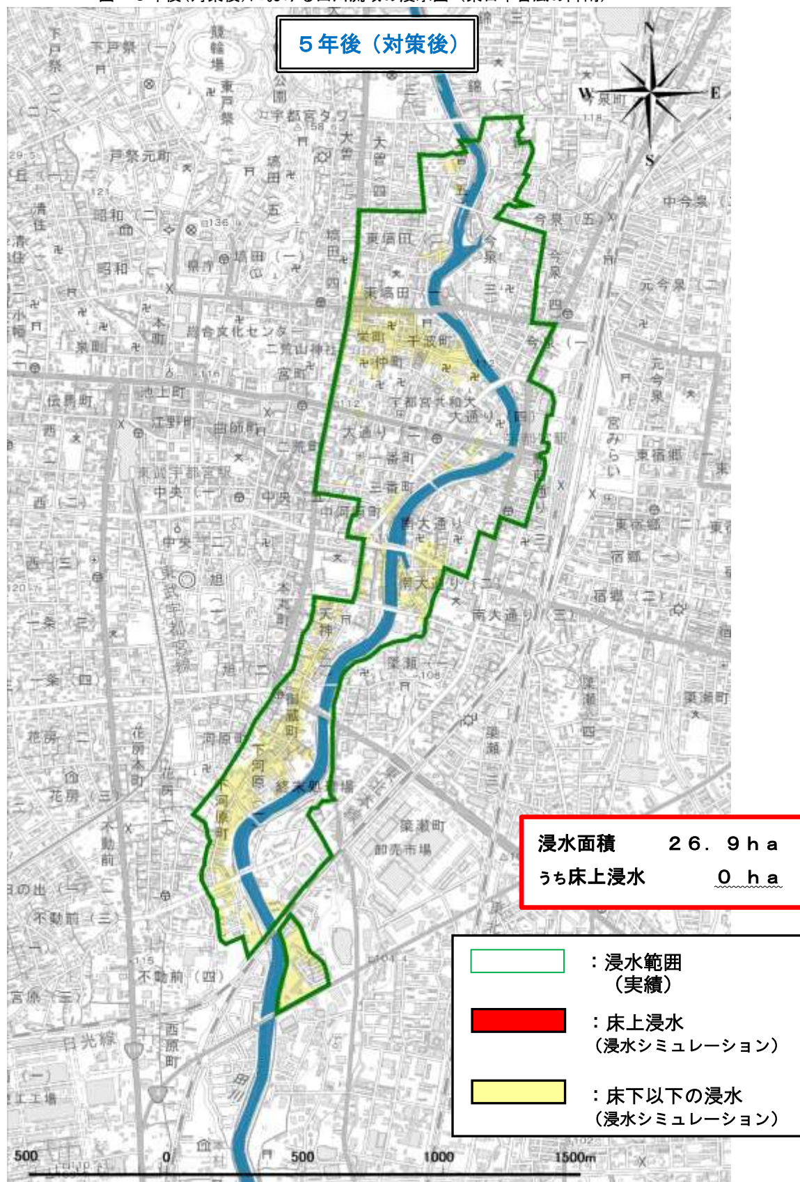
図 5年後(対策後)における田川流域の浸水図(東日本台風の降雨)
