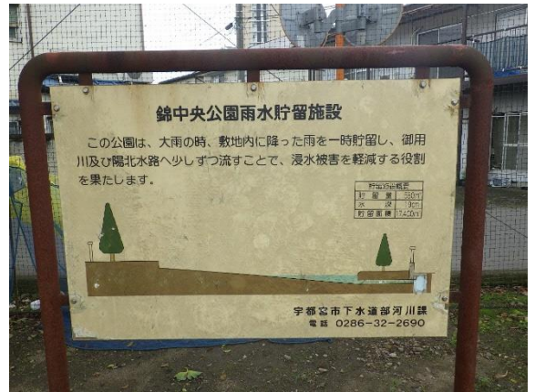
図 3.6 公園のグラウンドを活用した雨水貯留（オンサイト貯留）
