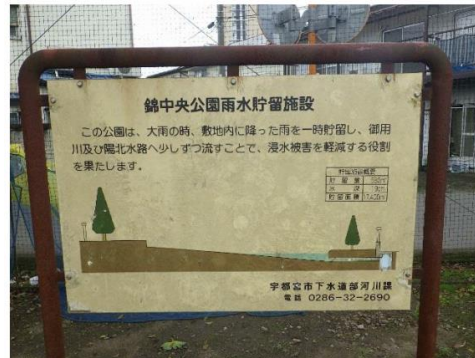
公園のグラウンドを活用した雨水貯留 (オンサイト貯留)
