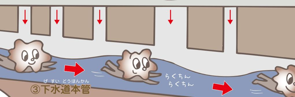
下水道は管の傾きを利用して高い所から低い所へ自然に水が流れるようにしています。
