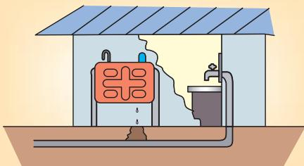
ご家庭で使用される水道管の多くは、灯油が浸透しやすい材質でできているため、庭先などで灯油がこぼれ、それが地中の水道管にしみ込むと、水道水が油臭くなることがあります。灯油がこぼれてしまったら、すみやかにその部分の土を入れ替えてください。水が油臭くなってしまった場合は、水道管の取り替えが必要になりますので、\*指定給水装置工事事業者へご連絡ください。
