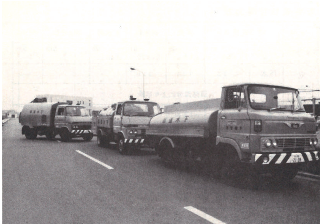
管渠清掃用車輛（右から給水車、洗浄車、吸泥車）
