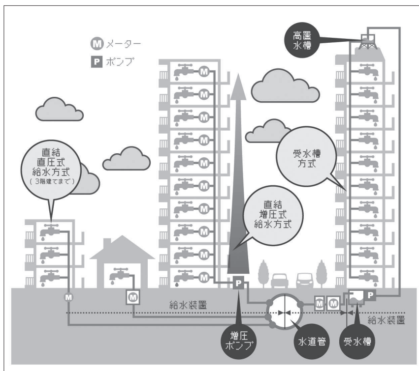
図7-9 直結直圧式給水と直結増圧式給水の仕組み(『うつのみやの水道と下水道』)
