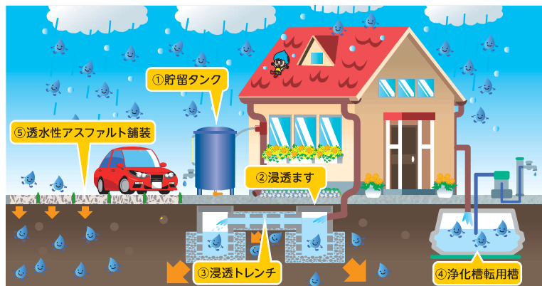
雨水貯留・浸透施設のイメージ
