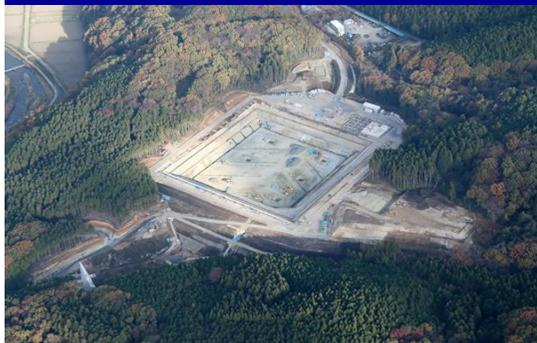
埋立地の造成が完了し、埋立地の形(正方形)が確認できます。また、地下水集排水管が埋立地底面に確認できます。
