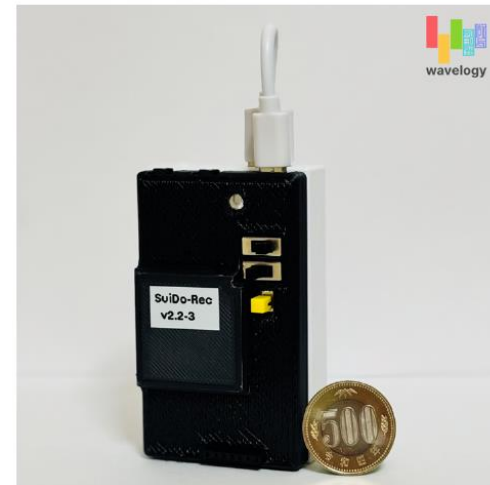
<漏水検知ツールと収集したデータの可視化イメージ>
