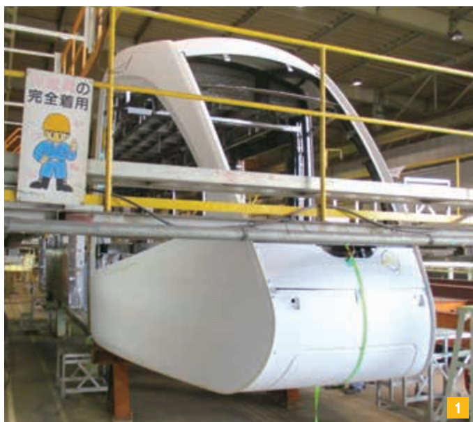
1 車両先頭部。骨組みの上に模型を組み立て、実際の作業の準備をしています。 2 車両胴体部の内装。3 車両胴体部の塗装。
