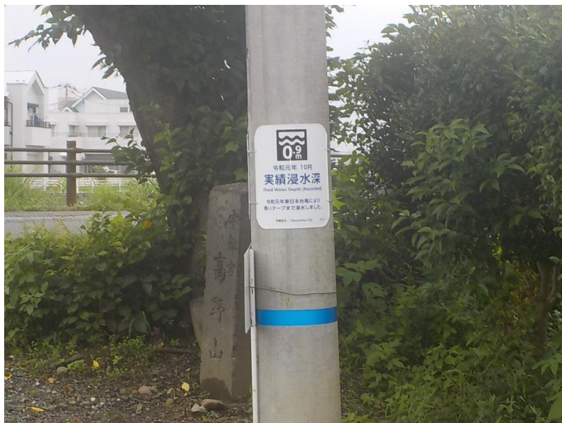
図 3.27 実績浸水深の電柱への表示
