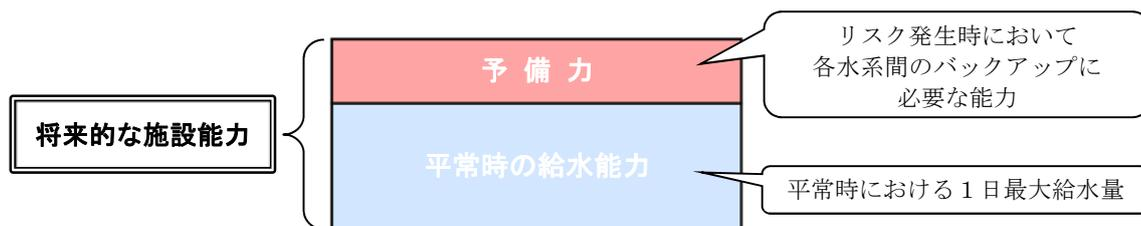
図4-2 将来的な施設能力の考え方
