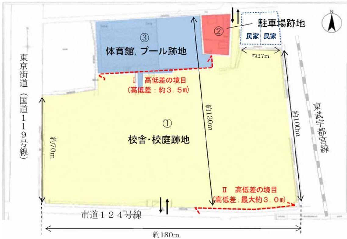
上図の①と③は最大約3.5mの高低差があり、①の方が③よりも高くなります（I）。また、①と市道124号線との境界についても、最大約3mの高低差があり、市道124号線は東方面に下がっています（II）。②については、段状（2段）の土地になっています。
