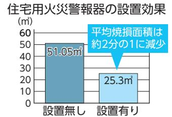
被害を軽減できることがわかります。火災の発生を早期に発見し、被害を軽減するため、未設置の場合は、速やかに設置してください。
