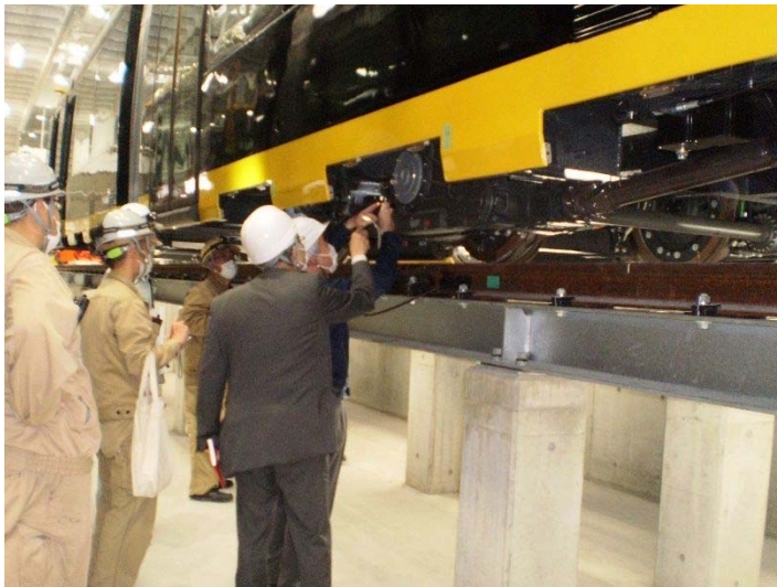
台車と車体との離隔測定
