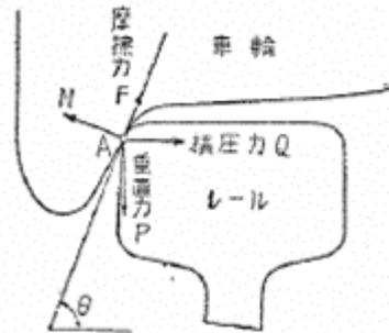
図 車輪とレール間の力
