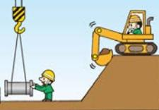
道路を直接機械で掘削して、下水道管を埋設する方法です。管を深い場所に埋設する場合やガス管などの地下の埋設物が支障にならない場合などに用いられます。
