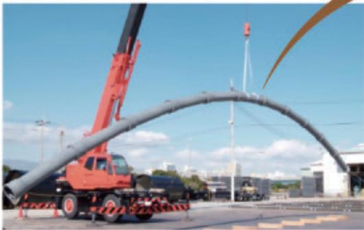
耐震管吊り下げ試験(日本ダクタイル鉄管協会 提供)
