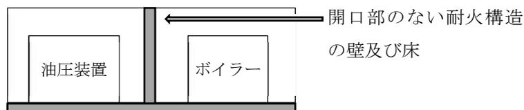
図 2-2-4 隣接して設置する場合の例
