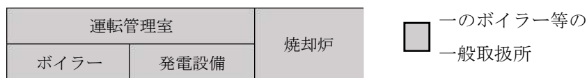
図 3-13-5 非危険物取扱部分を含めた建物全体を 一区画室単位とした一般取扱所の例
