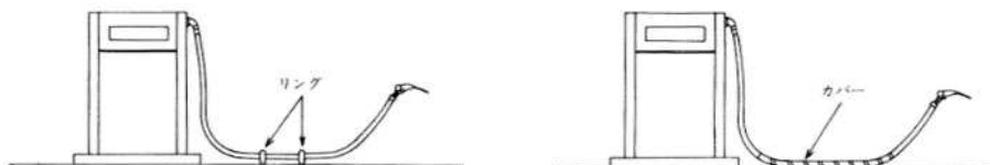
図 3-10-12 リング，カバーが取り付けられた給油ホース等
