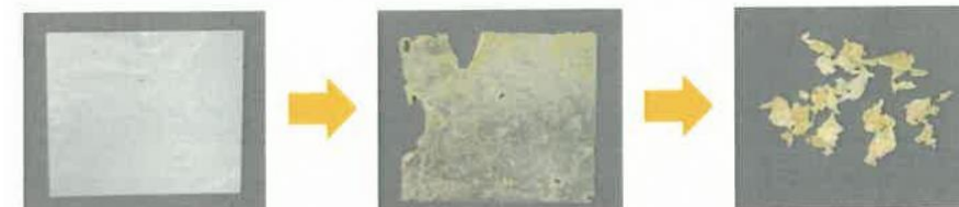
生分解性マルチの土中での分解過程
