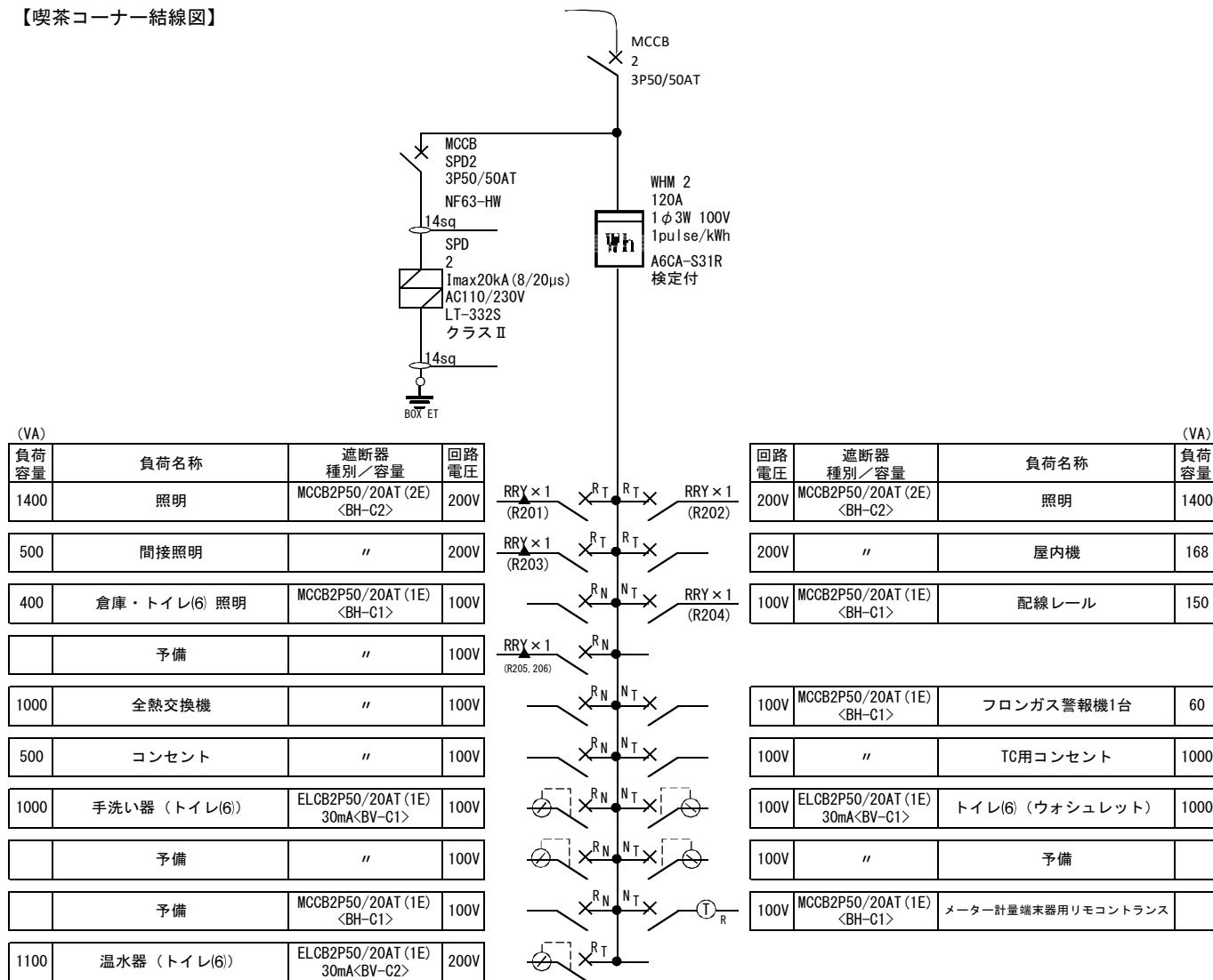
※ 既設以外のコンセントを設置する場合、倉庫内のS-F盤を使用し、自らの負担で工事すること。その際の最大電気容量は、三相の機器は15kw、単相の機器は18kVAまでだが、厨房部に排気フード等を設置する場合、送風機の容量が三相0.372kw、排風機の容量が三相0.3kwのため注意すること。
